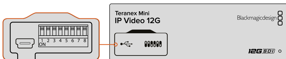
Настройку переключателя 1 меняют с помощью авторучки
