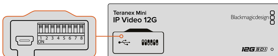
使用标配前面板时，您可使用笔尖上下拨动1号开关，将设备设定为源设备或目标设备
